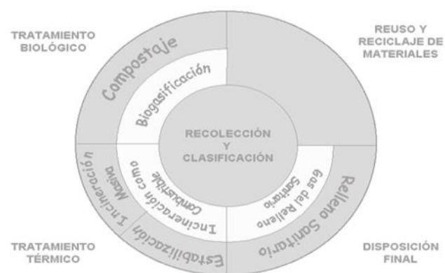
Figura 2: Diagrama del manejo integral y sustentable de residuos sólidos
