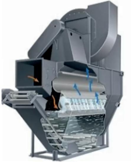
**Figura 2. Esquema del Rotoclone**
