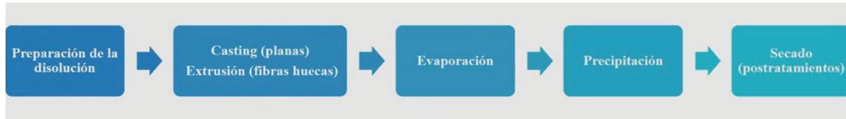
**Figura 5. Proceso de preparación de membranas por separación de fase**
