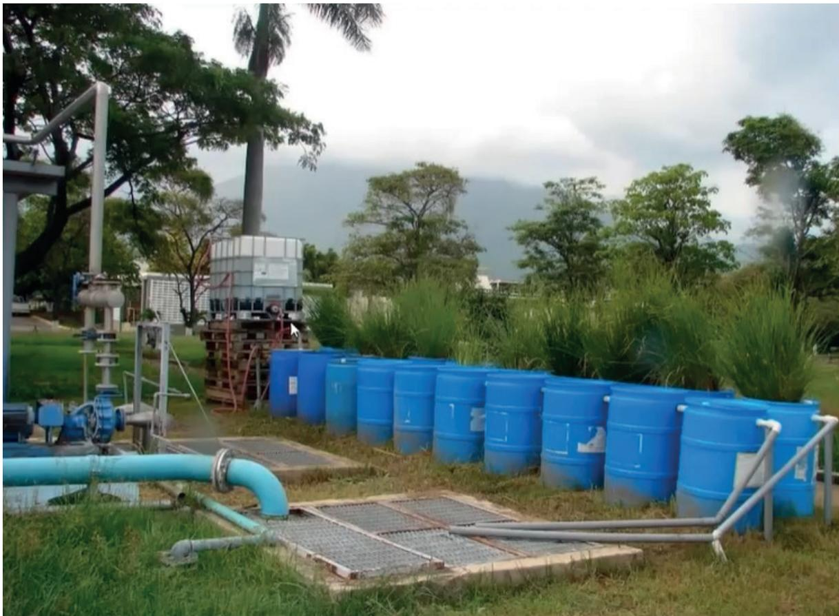
**Figura 3. Plantación de vetiver como biofiltro para una planta de alimentos**
